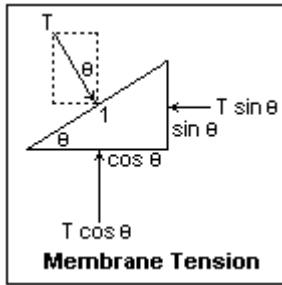
Prvo treba razmotriti horizontalne komponente ovih sila. Ove komponente su dobivene množenjem sila s kosinusom kuta otklona. Kako su ti kutevi mali, njihovi kosinusi su jednaki 1. Zato su horizontalne komponente sila na suprotnim stranama približno jednake. Tako je gibanje dijelova membrane u horizontalnom smjeru zanemarivo maleno. Iz ovoga se može zaključiti da se membrana giba transverzalno odnosno da se svaki djelić membrane giba vertikalno.
